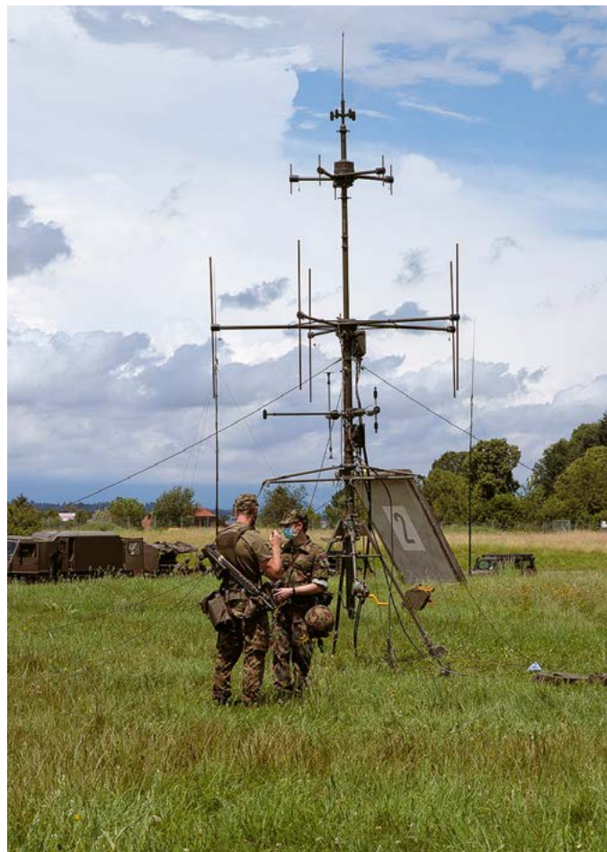
Antenne goniométrique de la GE, composant sensoriel de l'IFASS.
