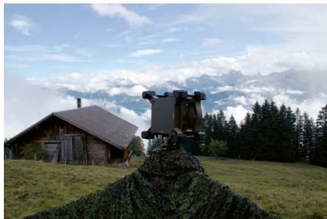
Antenne à ondes dirigées
